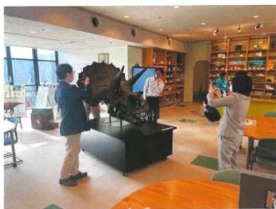
トリケラトプス化石のレプリカの3Dスキャンの様子。縦横、1点につき15分程度でかなりの高精度3D画像が取得できており、実用レベルに達している。
